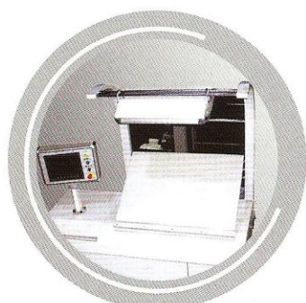
8. 燙金加熱系統控制中心 HEATER ZONE CONTROL CENTER
