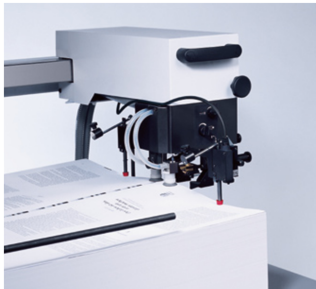
Подвижные воздушные раздувы устройства Tremat улучшают процесс разделения листов.
