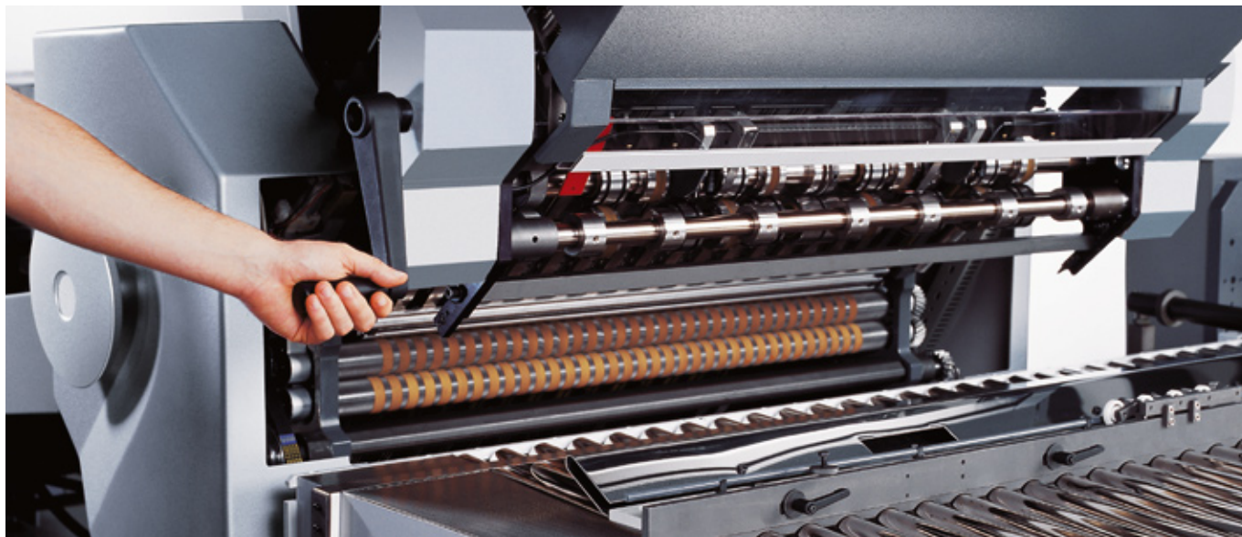
Устройство подъема инструментальных валов для облегченного доступа.
