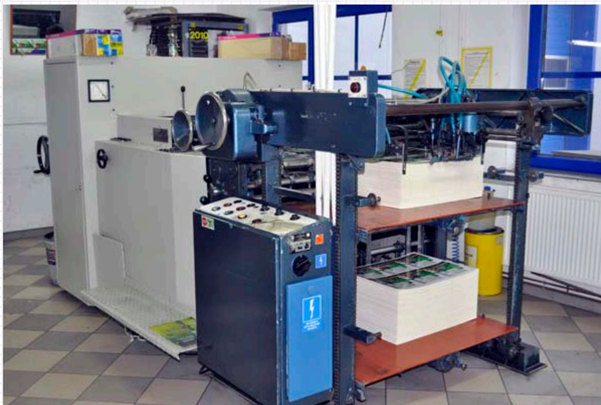
штамцевальный автомат Кама TS-96 (внешний вид)
